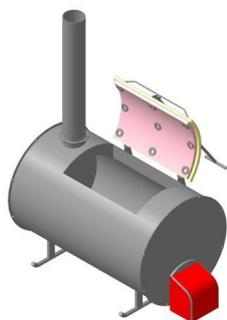
Корпус установки и камеры сжигания выполнен из углеродистой стали толщиной 2 мм.
